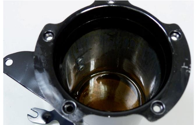
Abbildung 2: Alter Dieseldieselkraftstoff im Filtergehäuse
